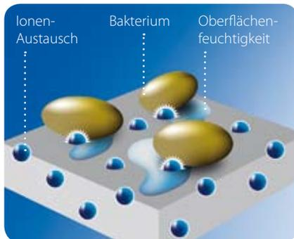
1000 Stunden in der Klimakammer einer konstanten Lufttemperatur von 40°C und einer relativen Luftfeuchtigkeit von 100 % (mit Betauung der Proben) ausgesetzt werden, ist keinerlei Rückgang der antimikrobiellen Wirksamkeit der Proben nachweisbar. Die Wirkung der Silberionen richtet sich dabei in dreifacher Form gegen die Vitalität schädlicher Mikroorganismen. Sie blockiert den Zellstoffwechsel, verhindert die Zellat-
